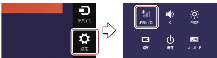
(2) 表示されたワイヤレスネットワークの一覧から、接続するネットワーク SSID を選択し、「接続」をタップ、または、クリックします。本製品のネットワーク SSID（プライマリー）は、本製品の側面にあるラベルに記載されている「プライマリーSSID」をご確認ください。
