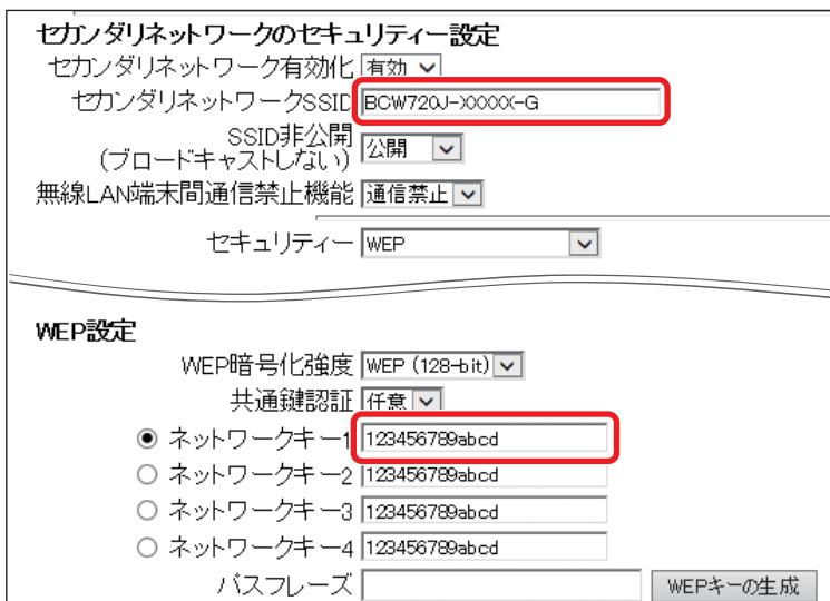
(7) 接続する機器に「セカンダリネットワーク SSID」と「WEP 認証用ネットワークキー」をそれぞれ設定すれば完了です。
