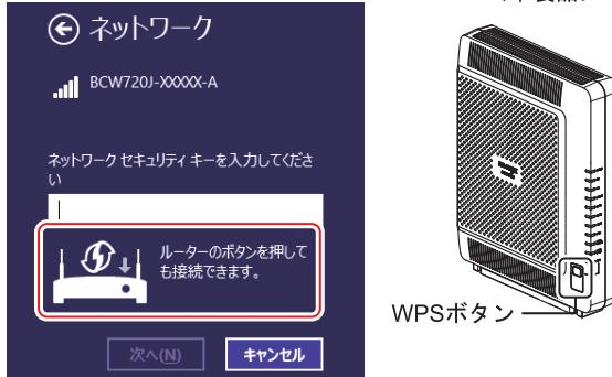
(4-2) 本製品の側面にあるラベルに記載されている「PASS KEY」を入力して「次へ」をタップ、または、クリックします。
